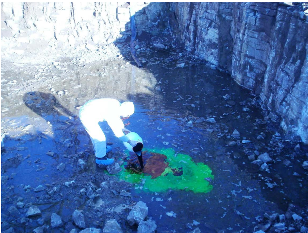
Photo 5 - injection de 2.5kg de fluorescéine dans une fosse
