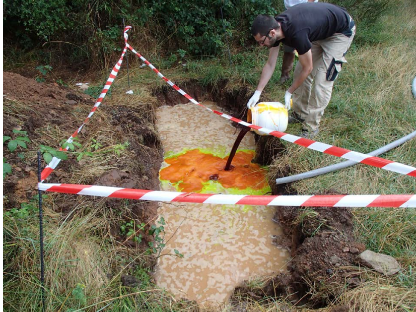
Photo 7 – injection de 1 kg de Fluorescéine dans la fosse réalisée au tractopelle
