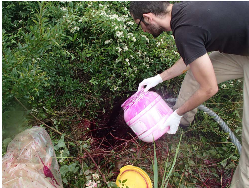
Photo 8 – injection de 0.8 kg de Sulforhodamine B dans une perte
