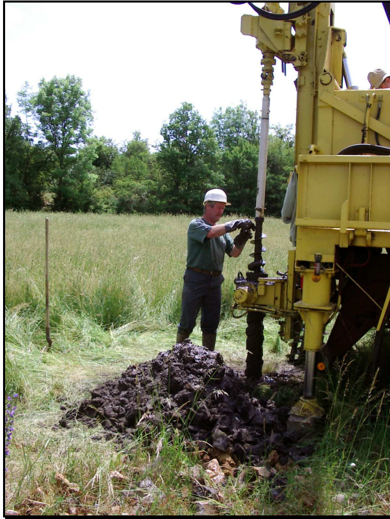
Figure 102 : Photographie : Une campagne de sondages menée avec le BRGM et l'Ecole des Mines de Paris nous a permis de recouper près de 50 mètres de dépôts argilo-sableux sombres, peut-être corrélatifs de l'existence d'un lac de maar.
