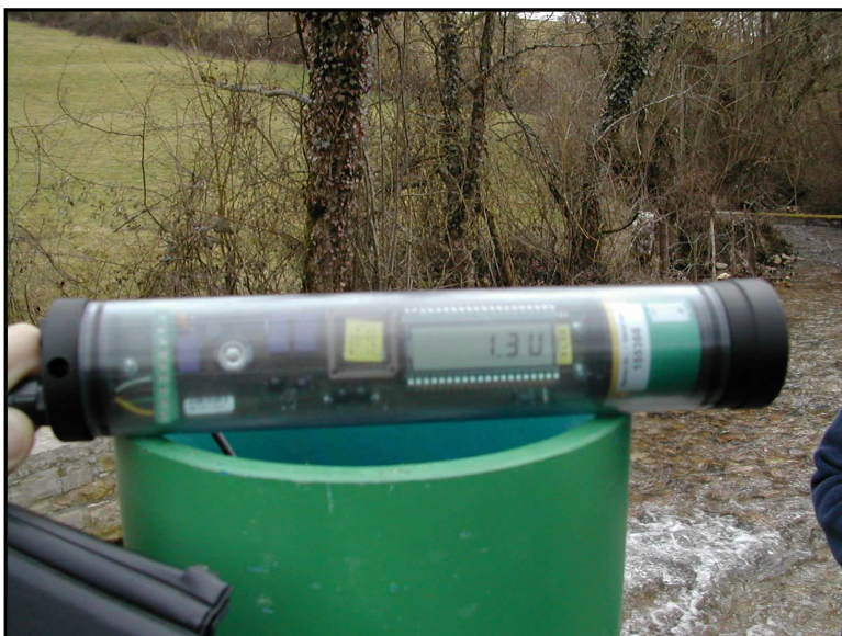
Figure 3 : Capteur d'un limnigraphe électronique
